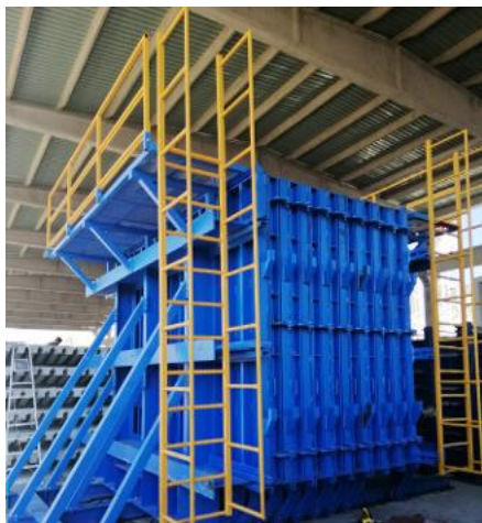
Дохук / ИРАК Вертикальная форма для стен (8 батарей)
